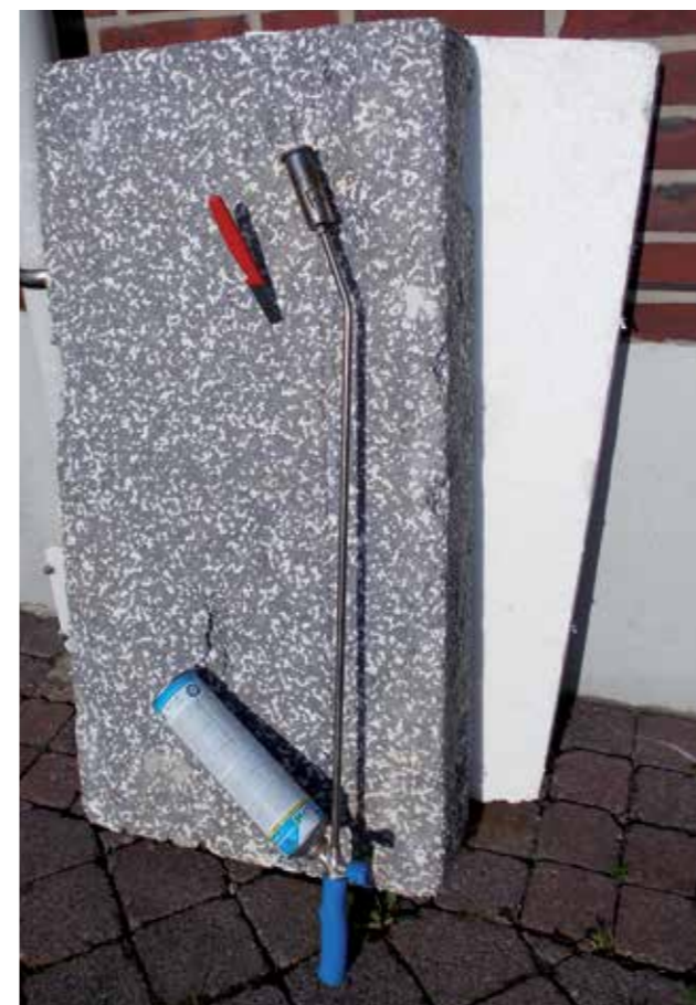
Der Grundstoff: eine 150 mm starke Fassadendämmplatte für die Rückwand, eine 80 mm starke Styroporplatte für die Seitenwände
