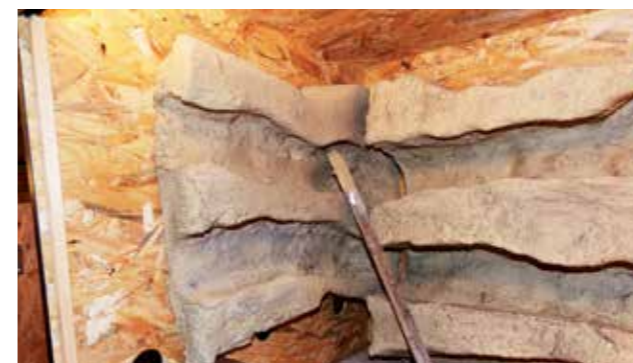
Ankleben an den Terrarienwänden; damit die künstlichen Rückwände halten, bis der Kleber getrocknet ist, werden sie gestützt.
