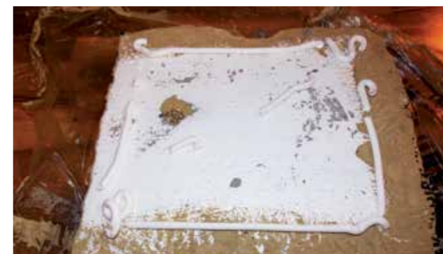
Zum Einkleben werden die Wände auf der Rückseite mit reichlich Montagekleber versehen
